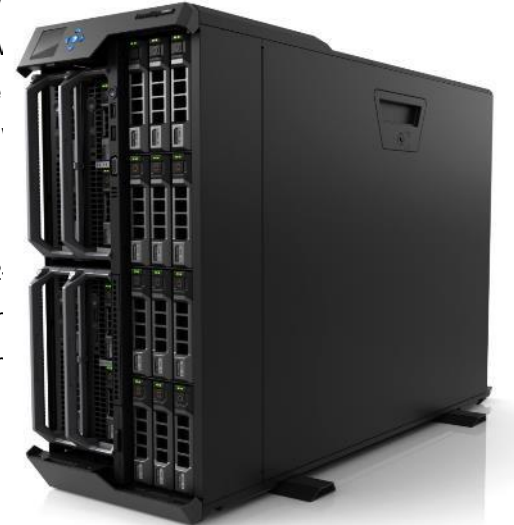
PowerEdge VRTX mit 4 halbhohen Server Nodes und 12x 3,5" HDD
